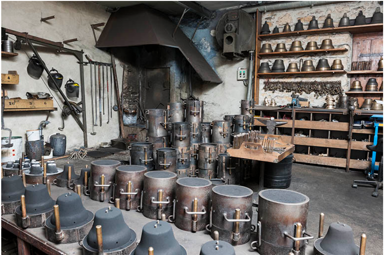
Atelier de fonderie : moules, châssis, foyer et modèles.
