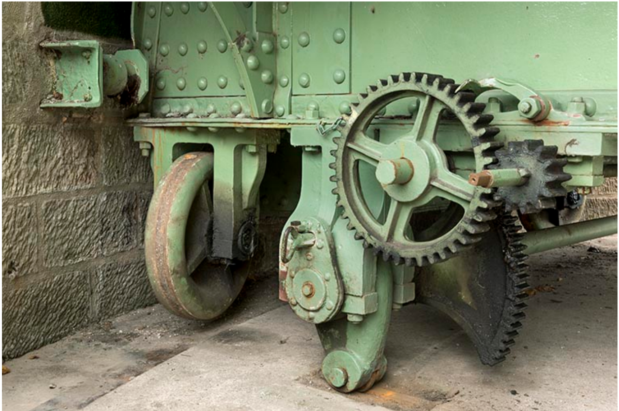
Détail du système de levage.
