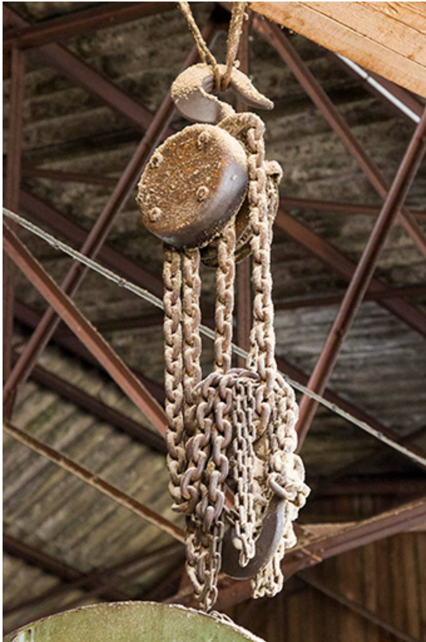
Atelier de fabrication de 1953 : palan manuel.
