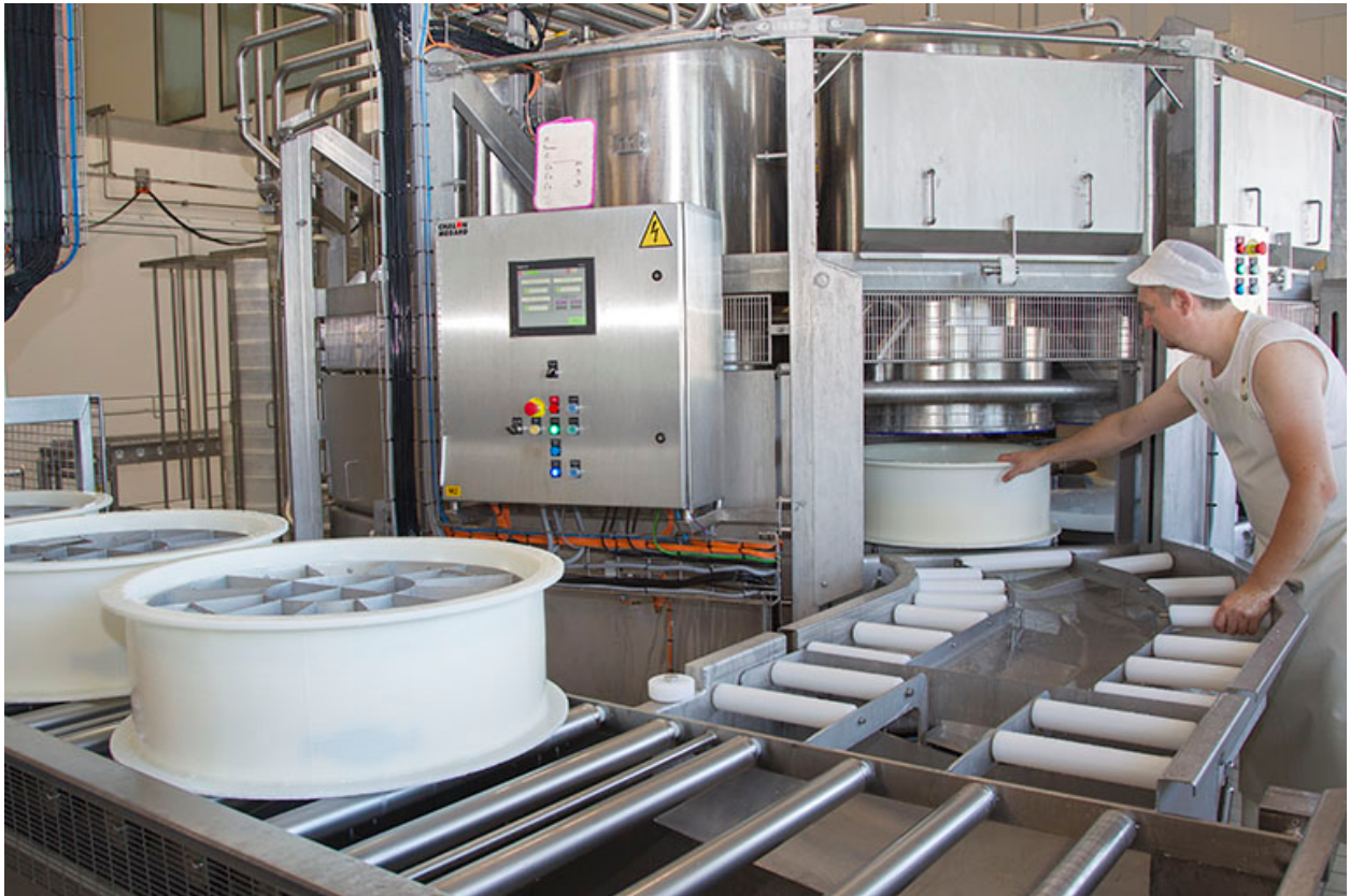
Fabrication : sortie du soutirage sous vide.
