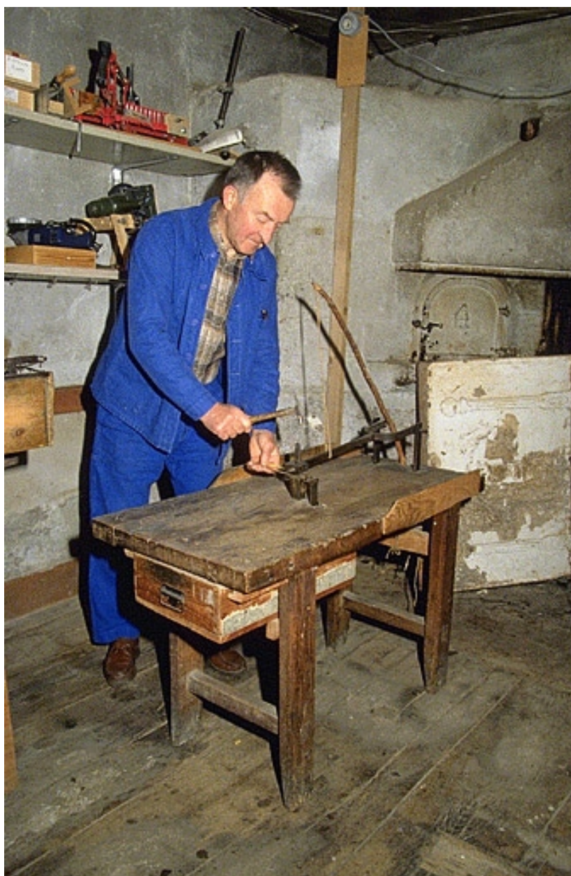
Poinçonnage d'une lame.
