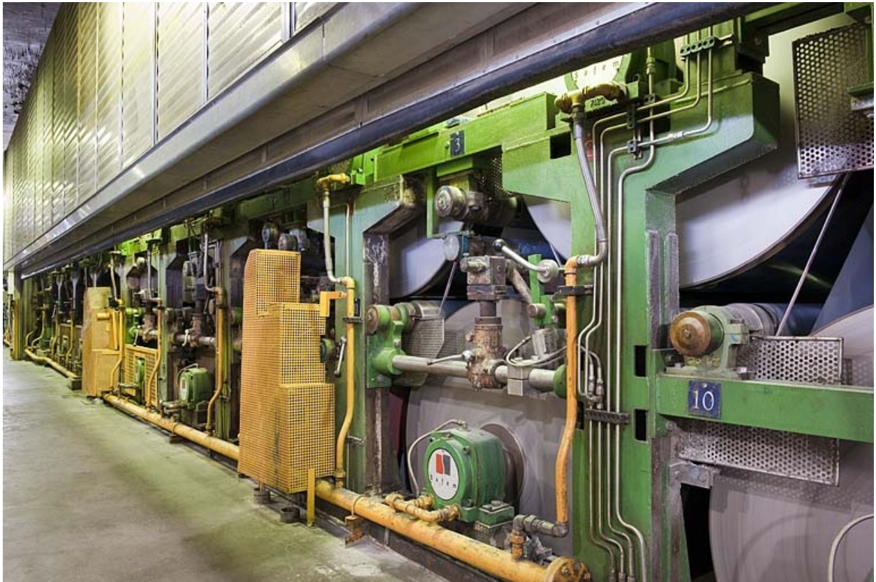
Machine à papier. Vue d'ensemble de la partie séchage.
