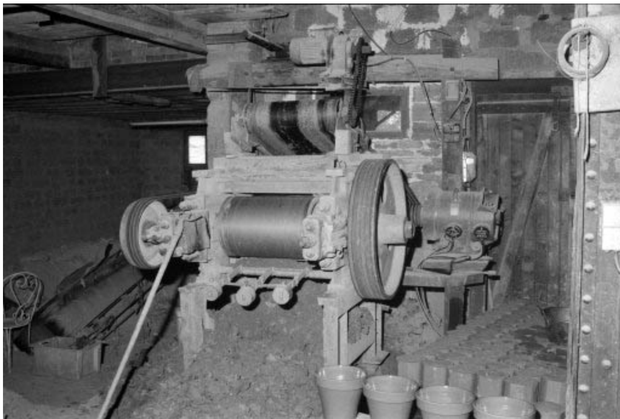
Broyeur UNICERAM (5). A droite, pâtons au sortir de la boudineuse et avant moulage.
