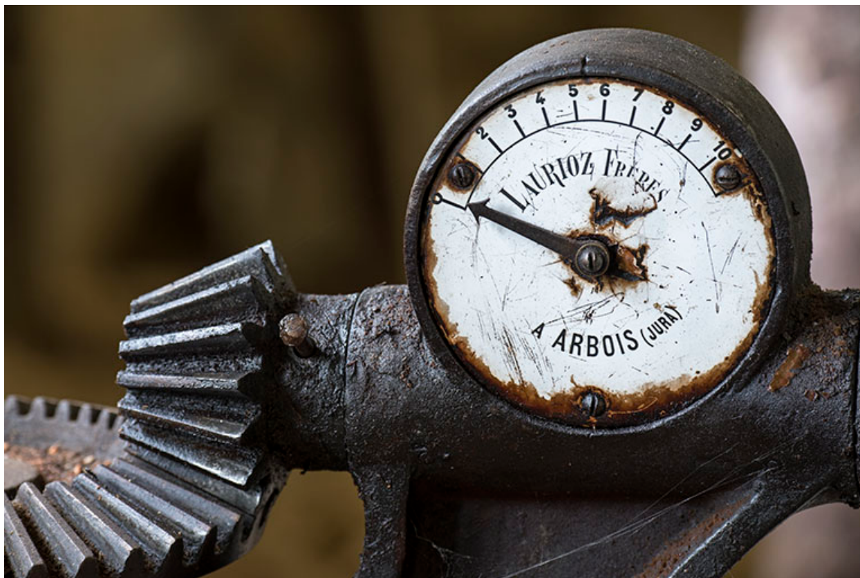
Manomètre de turbine Laurioz (usine d'outillage Louis Garnache-Chiquet et Fils, Les Gras).
