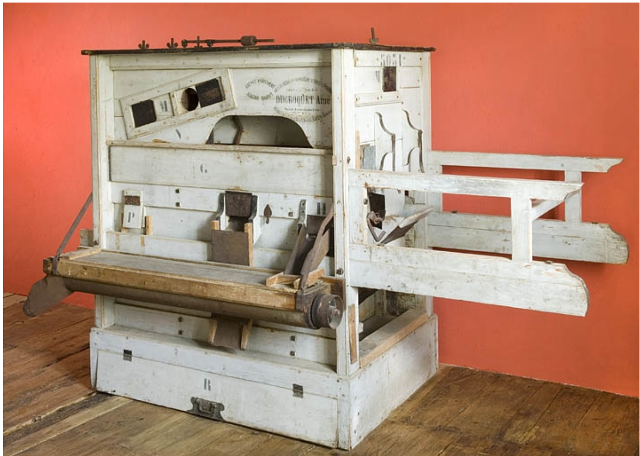
Nettoyeur-dépoussiéreur à grains. Vue de trois quarts.
