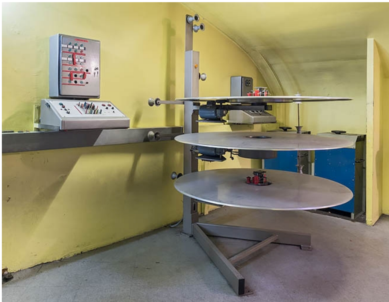
Pupitre à matrice à diodes et dérouleur à plateau Kinoton ST-270.
