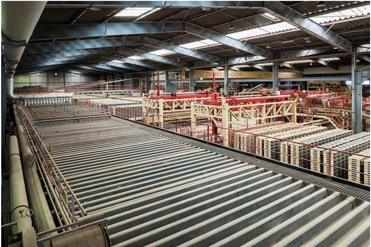
Tuilerie et briqueterie Migeon, à Lantenne-Vertière : unité de fabrication UL 2. La partie supérieure du four piscine occupe le premier plan.
