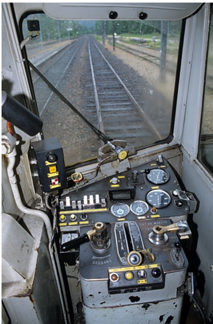
Intérieur, côté extrémité 2 : poste de conduite.
