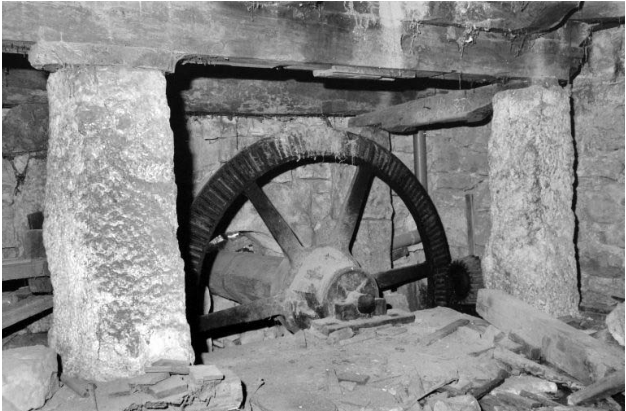
Transmission d'une roue hydraulique (2e étage de soubassement).
