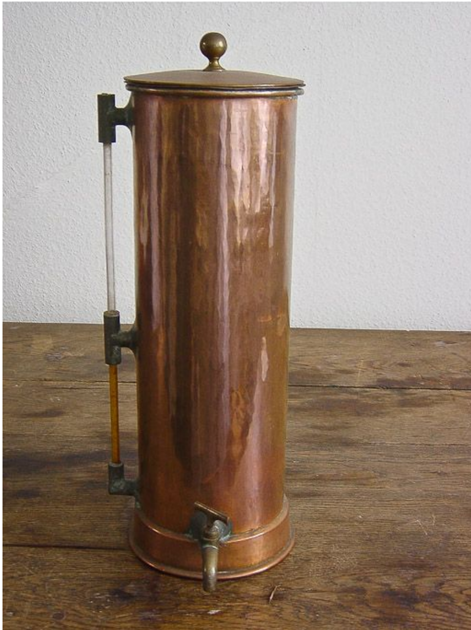
Vue du premier saccharolyseur.
