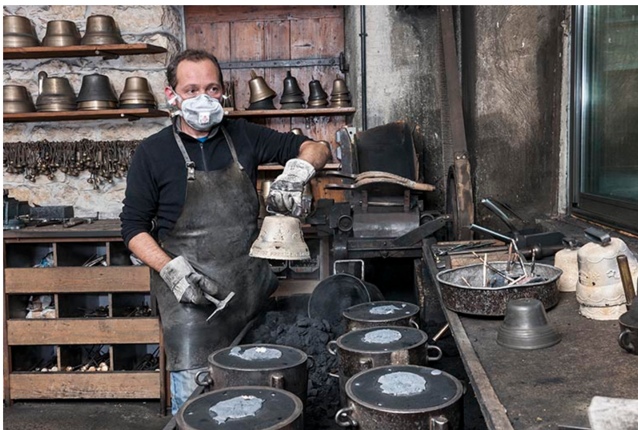
Démoulage. Extraction de la cloche (5).
