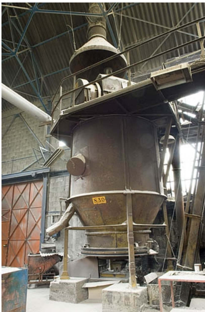
Equipement pour la préparation du sable de fonderie.
