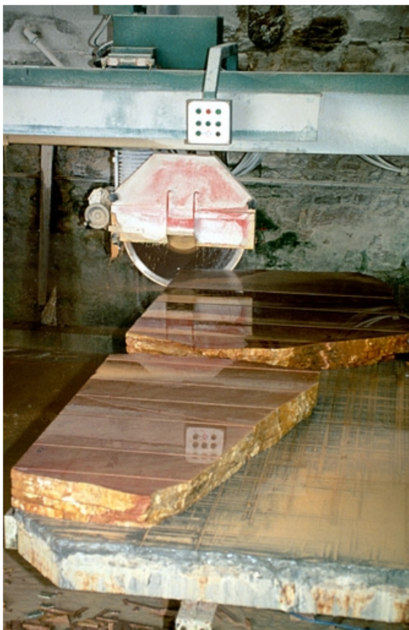
Débiteuse Gregori en cours de sciage : vue de détail.
