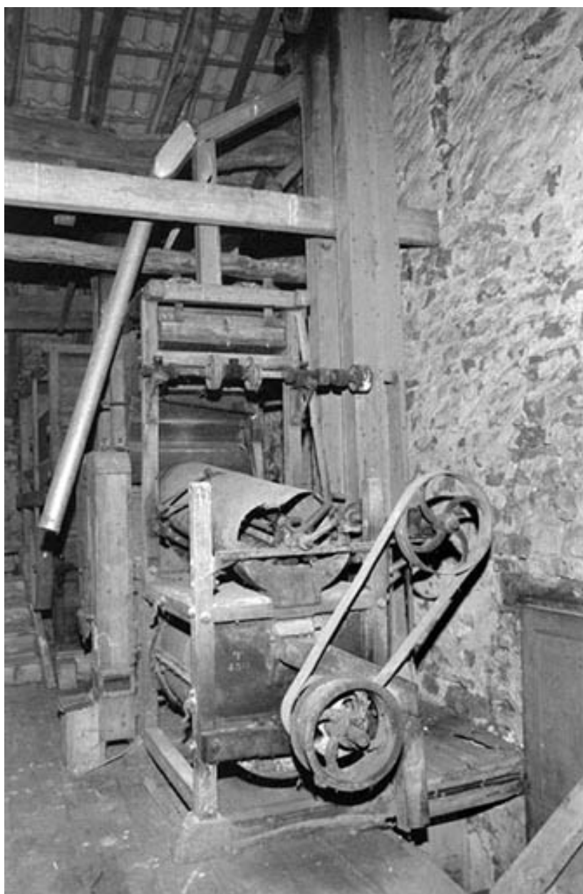
Trieur à grains (étage en surcroît).
