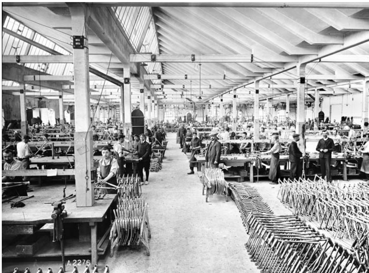
Atelier de fabrication de cadres de bicyclettes. Photogr., s.n., s.d. [vers 1912].
