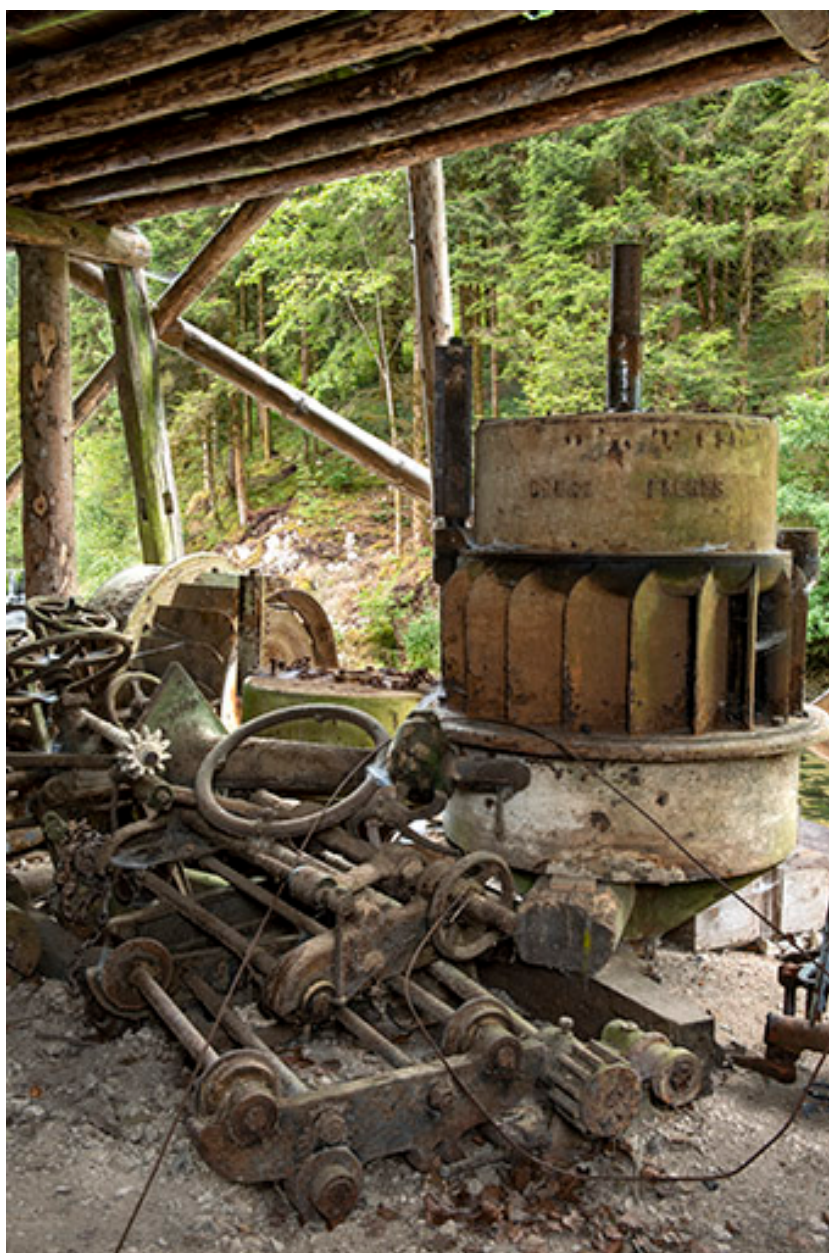
Turbine Douge et transmission démontées.
