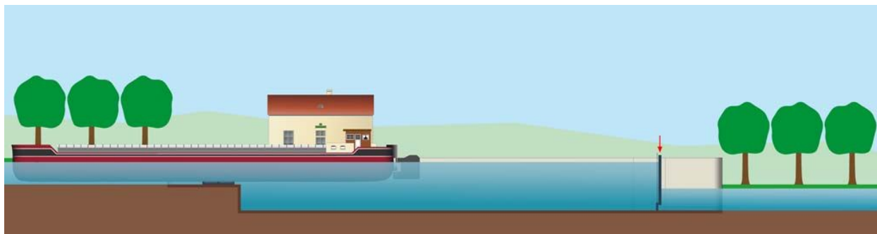
Schéma d'éclusage d'un bateau montant, étape 9.
