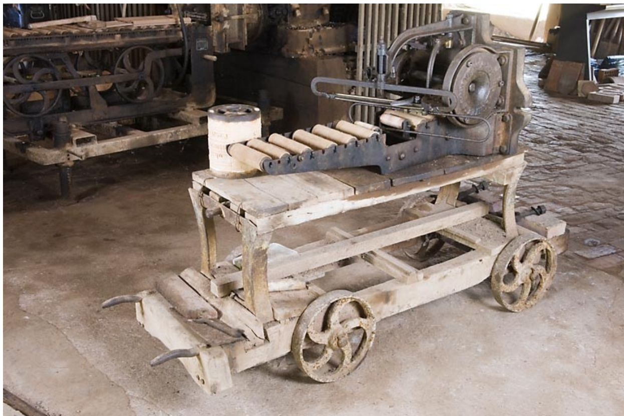
Mouleuse-étireuse pour tuiles sur son chariot découpeur.
