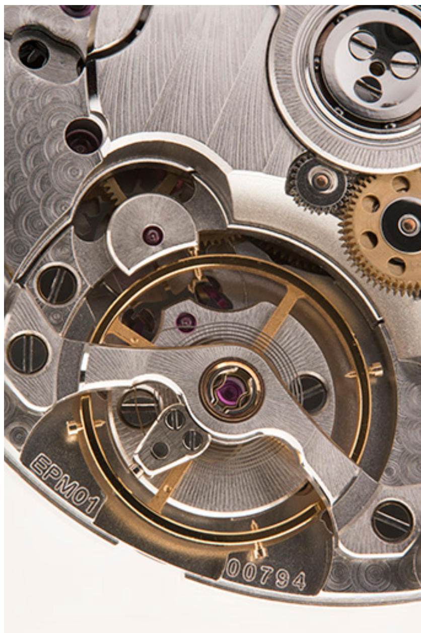
Face côté fond : balancier-spiral (vue rapprochée).
