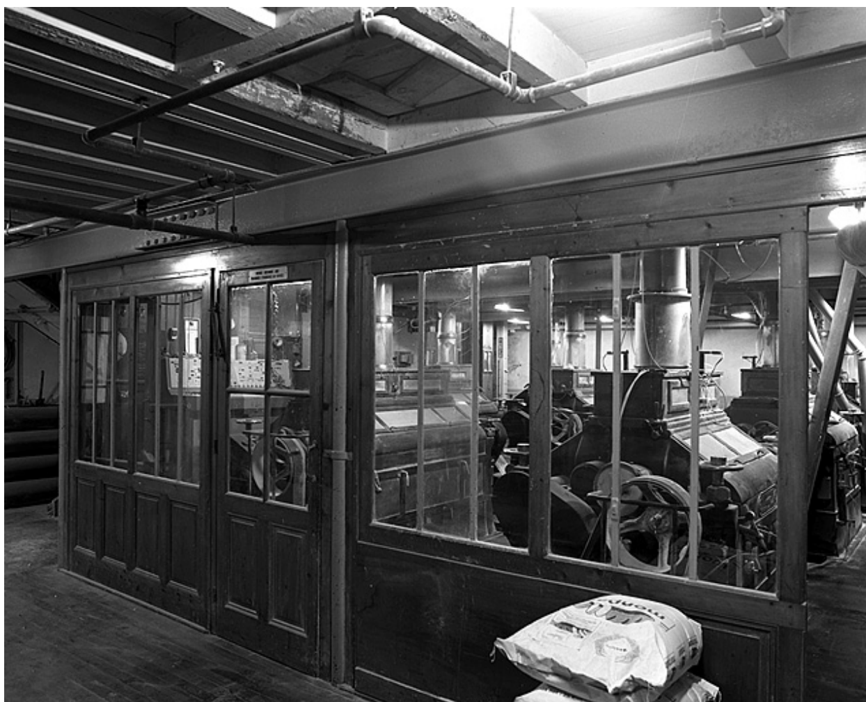
Pièce des appareils à cylindres.
