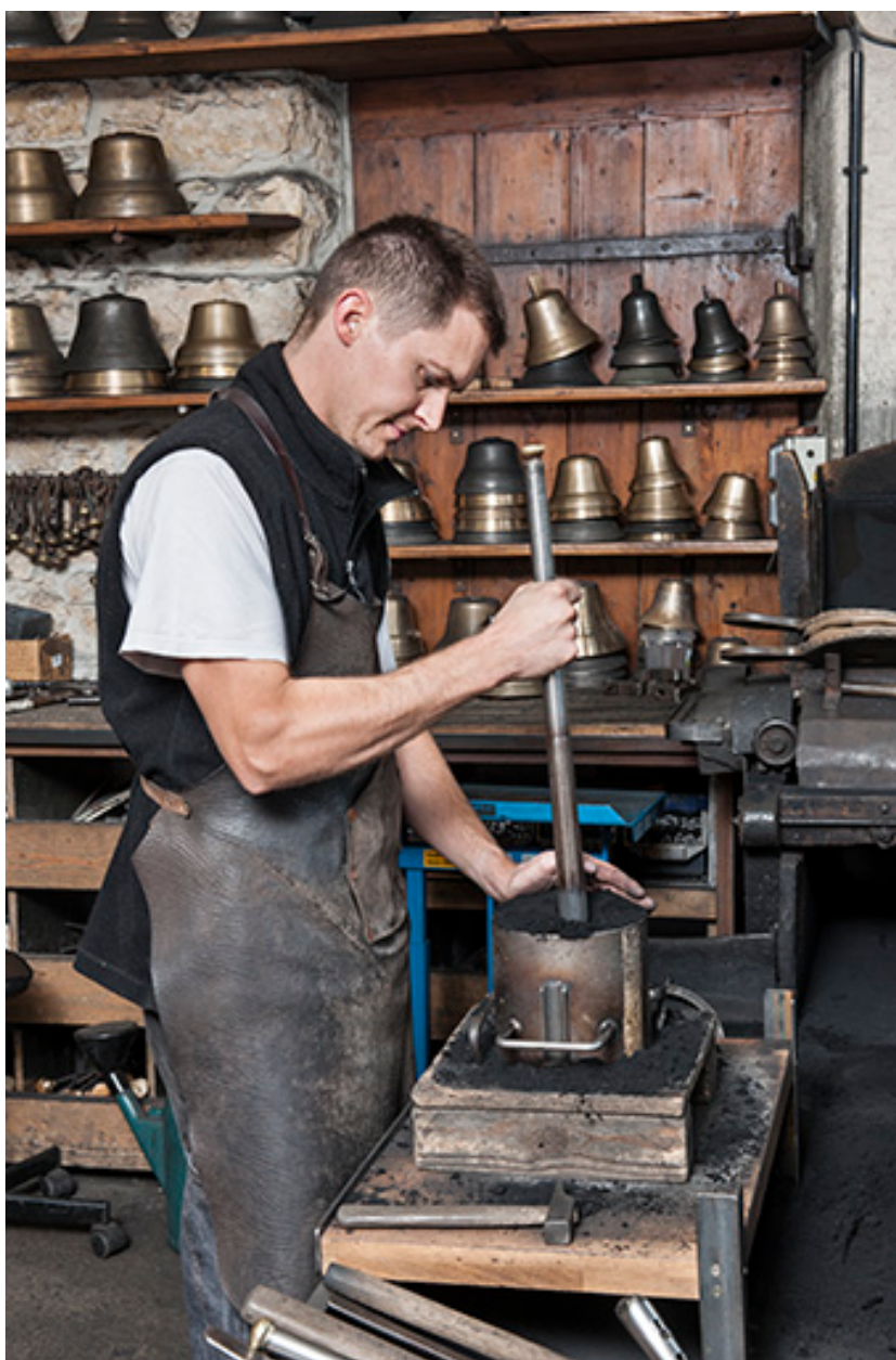
Moulage. Tassage au fouloir métallique (1).
