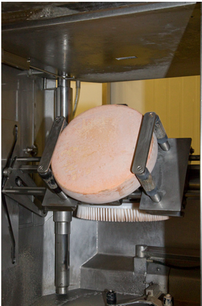
Fabrication du morbier : retournement d'une meule (robot).
