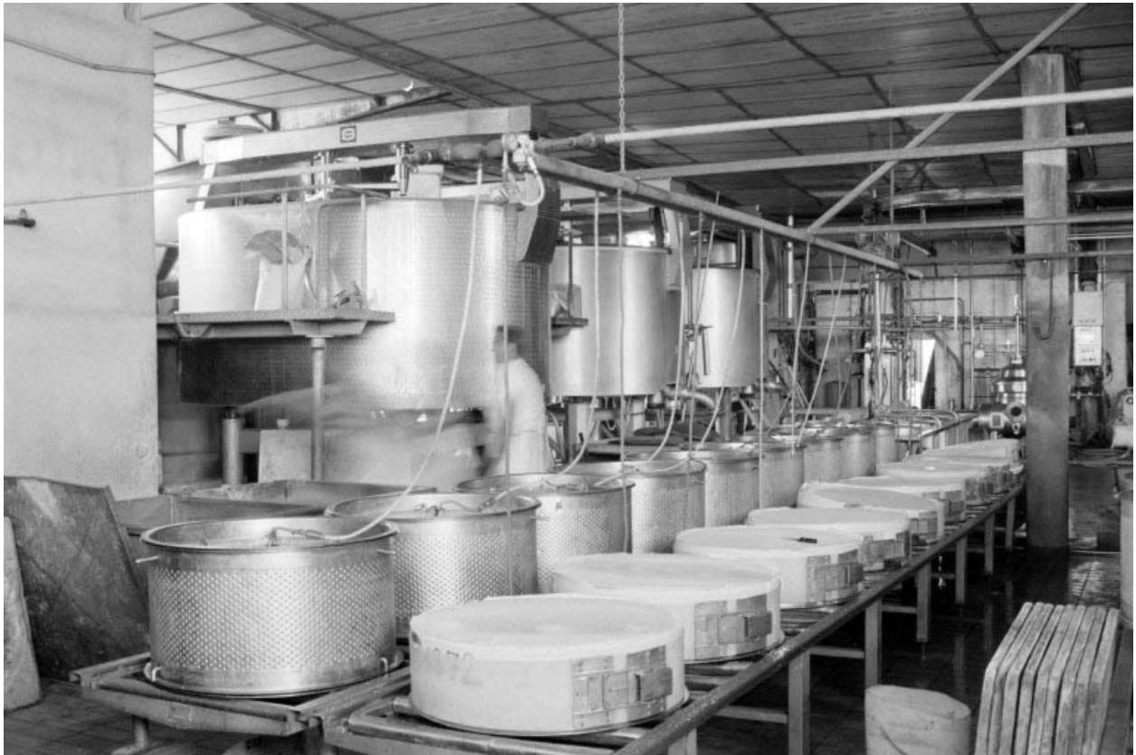
Intérieur de l'atelier de fabrication, à l'étage. Presses au premier plan, 3 cuves de 8000 l. à gauche.
