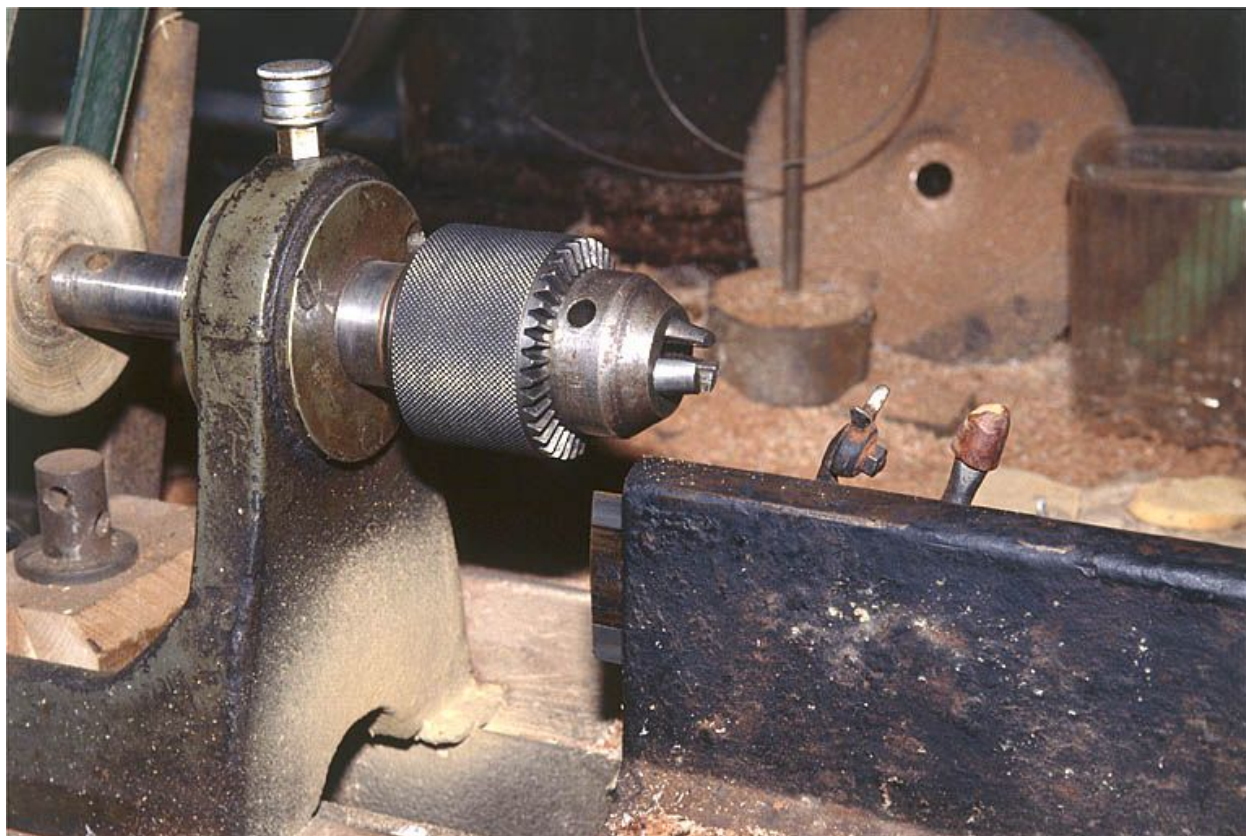
Détail de la machine équipée d'un mandrin de perceuse.
