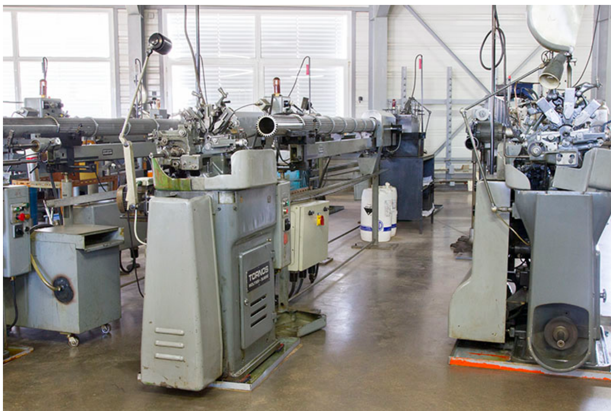
Deux machines à décolleter Tornos.
