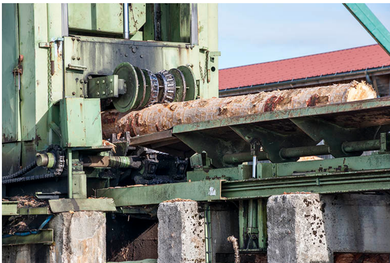
Détail du poste d'écorçage.
