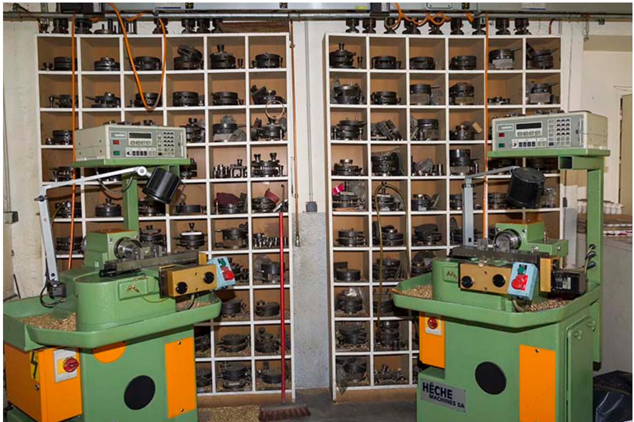
Usine, rez-de-chaussée : postes de travail (deux machines suisses Hêche et leurs outils).
