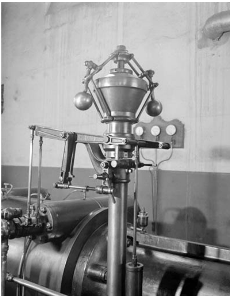
Salle des machines (10) : régulateur à boules de la machine à vapeur.
