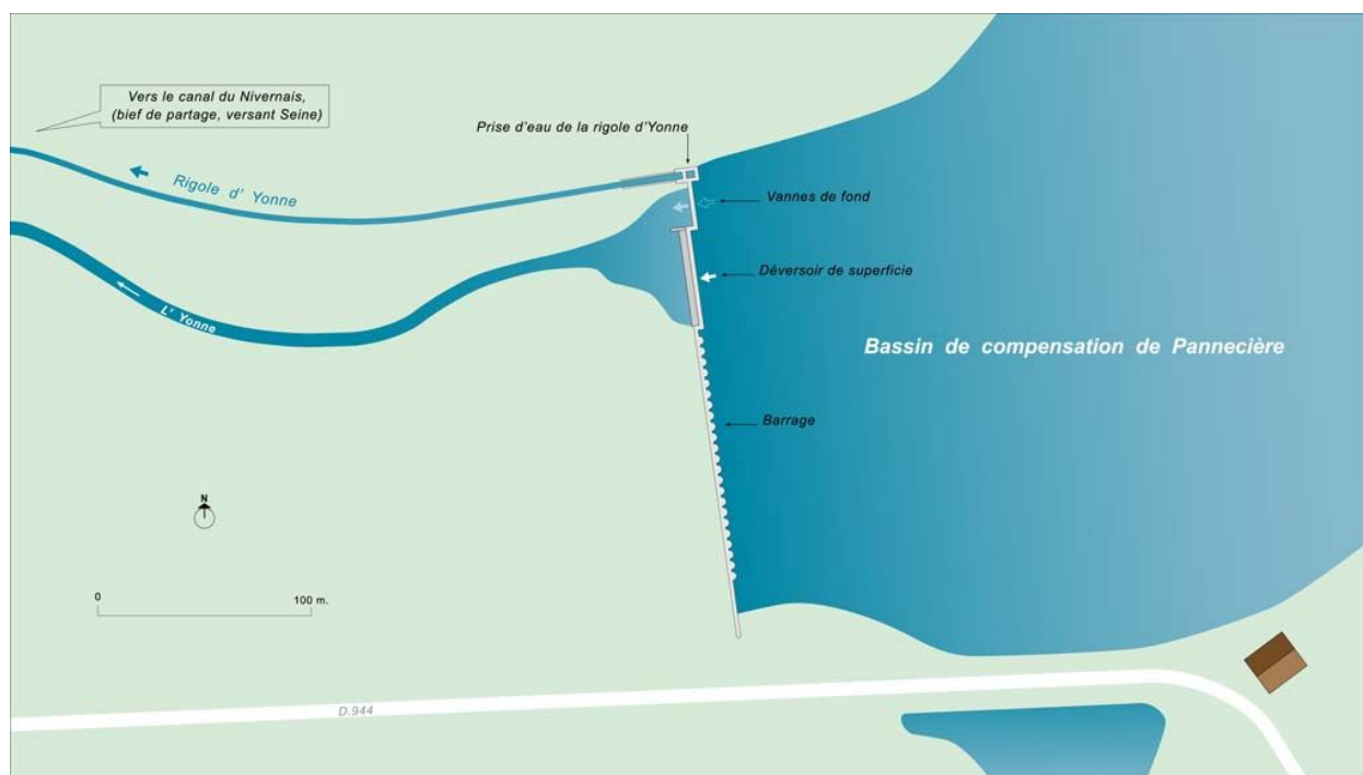
Carte schématique du bassin de compensation et de la prise d'eau de la rigole d'Yonne.
