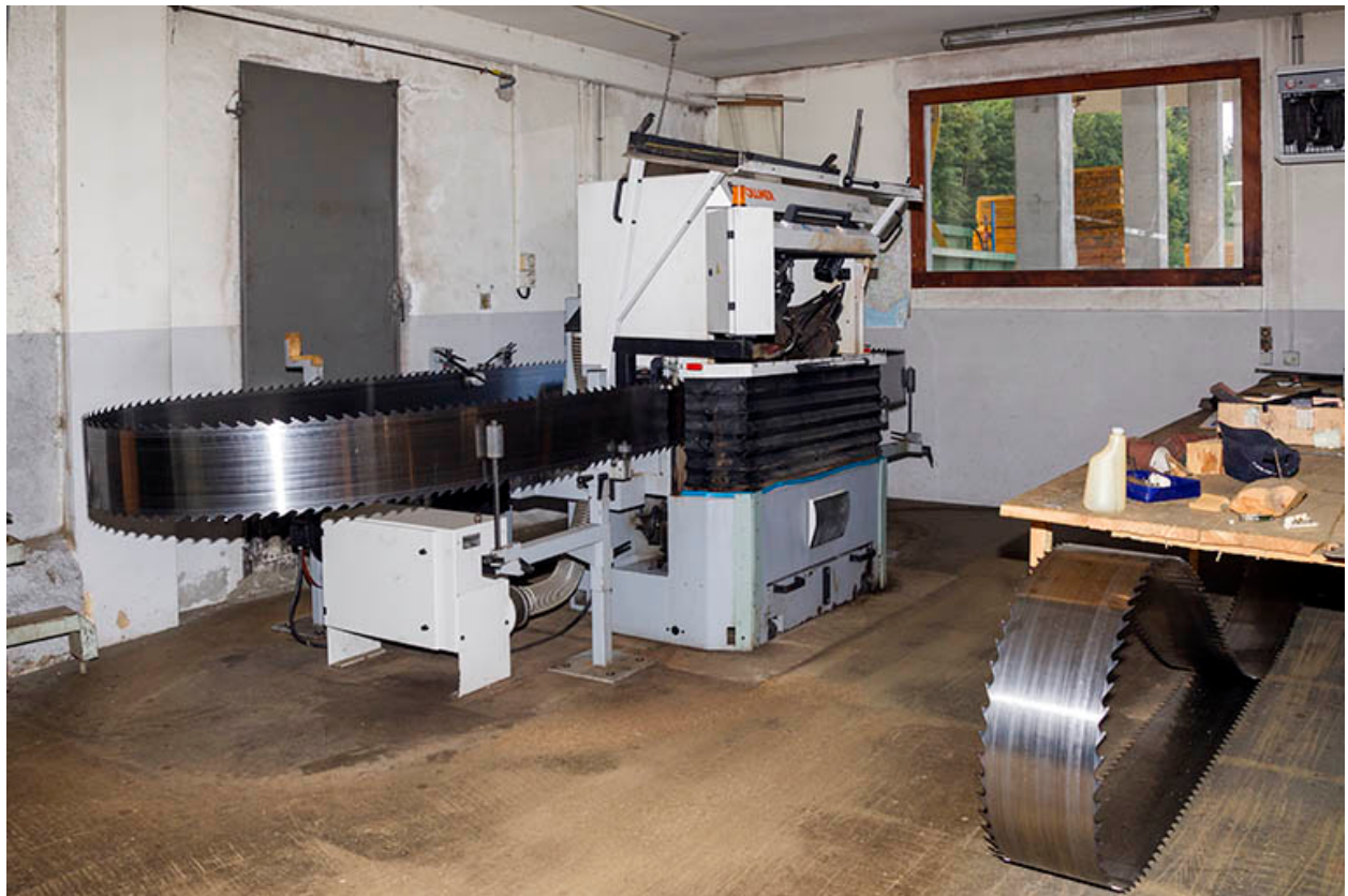
Atelier d'affûtage (K) : machine pour l'affûtage des lames de scie à ruban à double denture.
