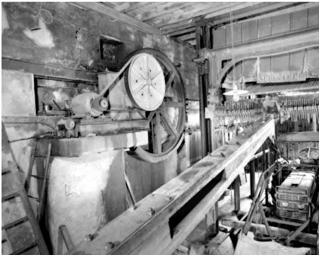
Noria : moteur et système d'entraînement.
