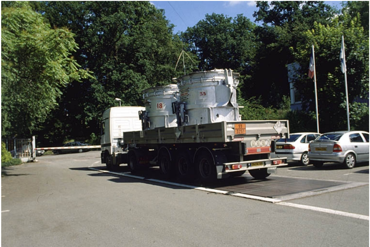
Camion chargé de deux poches d'aluminium liquide.
