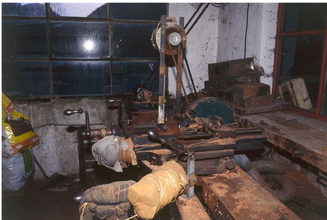
Machine à fraiser dite machine à aplatir.
