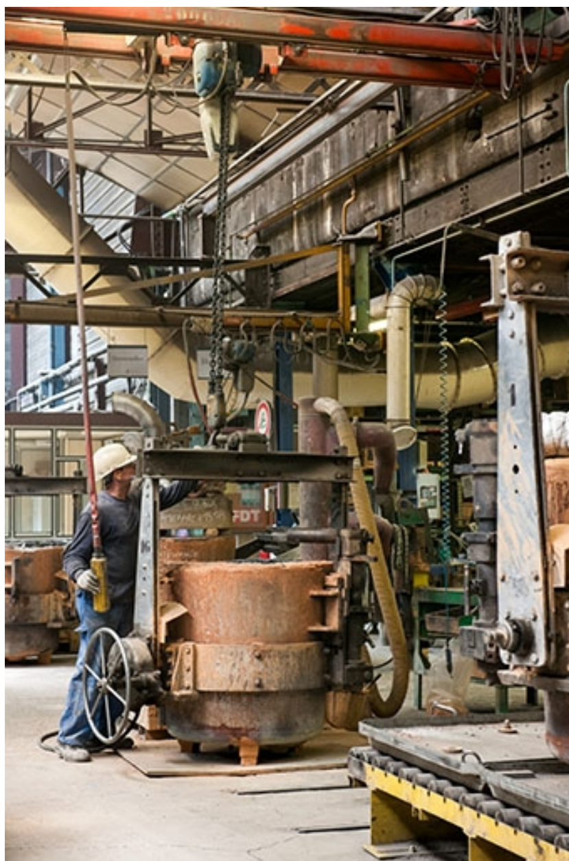
Manutention d'une poche de coulée.
