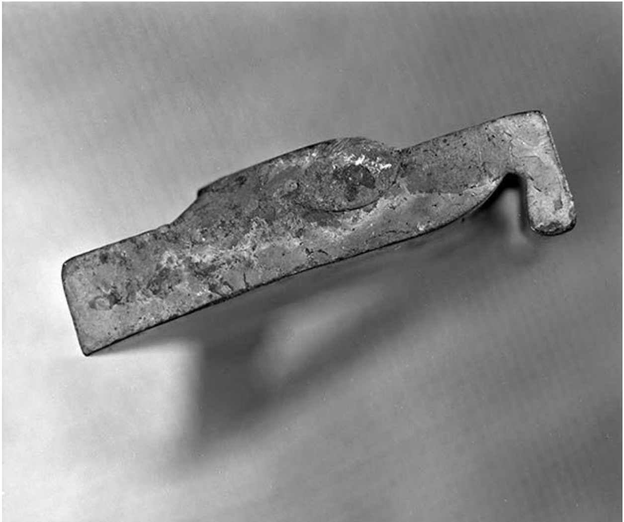
Profil d'un fer de forme servant à l'incrustation des motifs décoratifs sur le couvercle des tabatières.
