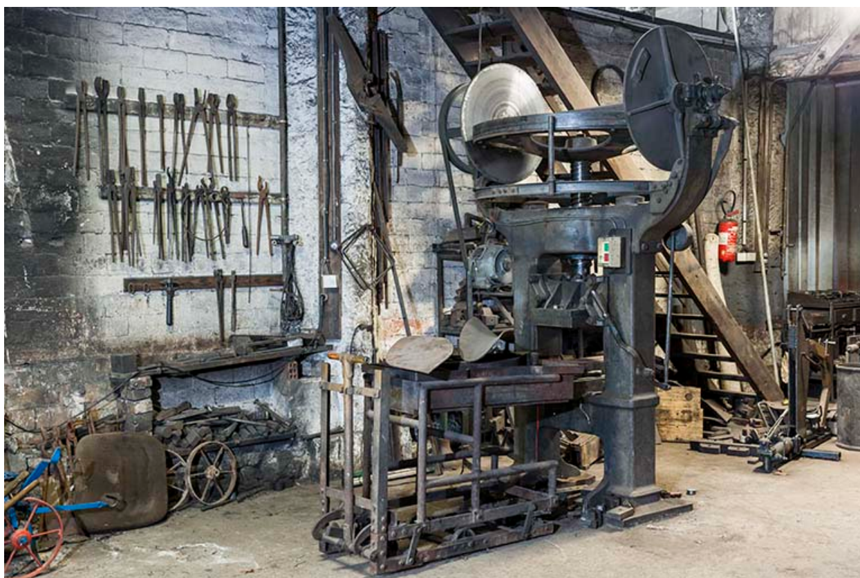
Balancier à friction (emboutissage des socs).
