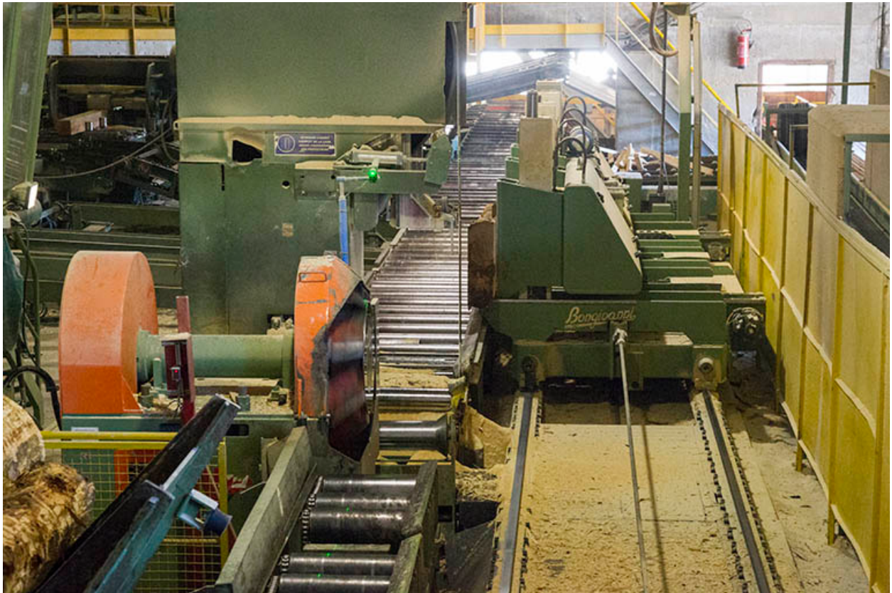
Atelier de débitage (N) : scie à ruban Bongianni et son chariot, vus de l'amont.
