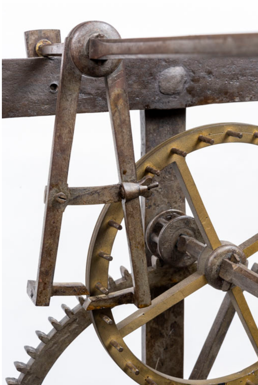
Echappement à chevilles : ancre et roue d'échappement.
