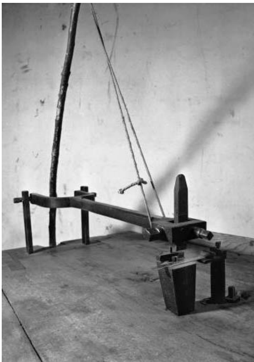
Banc à poinçonner : système de poinçonnage.
