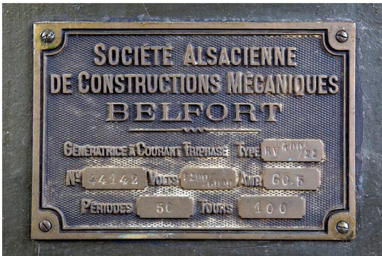
Plaque de constructeur d'un alternateur SACM.
