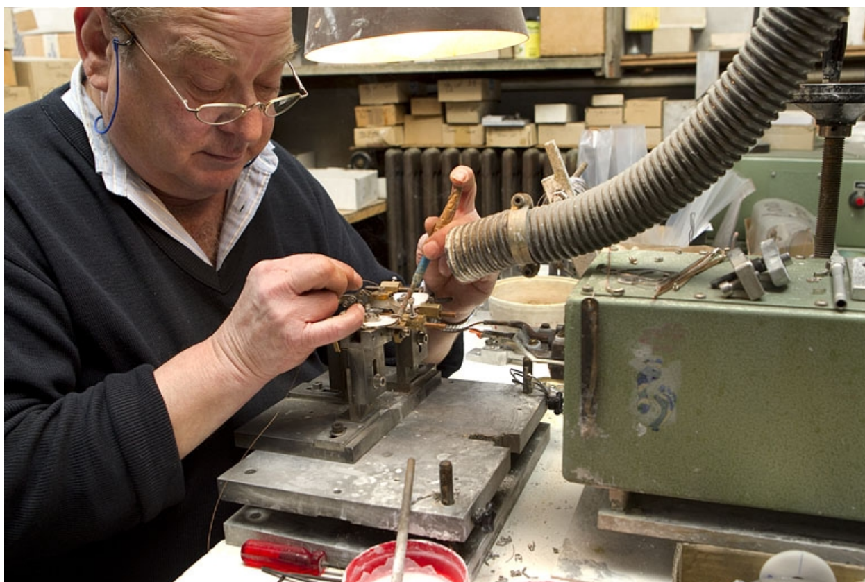
Soudage sur la machine à souder Himmel.
