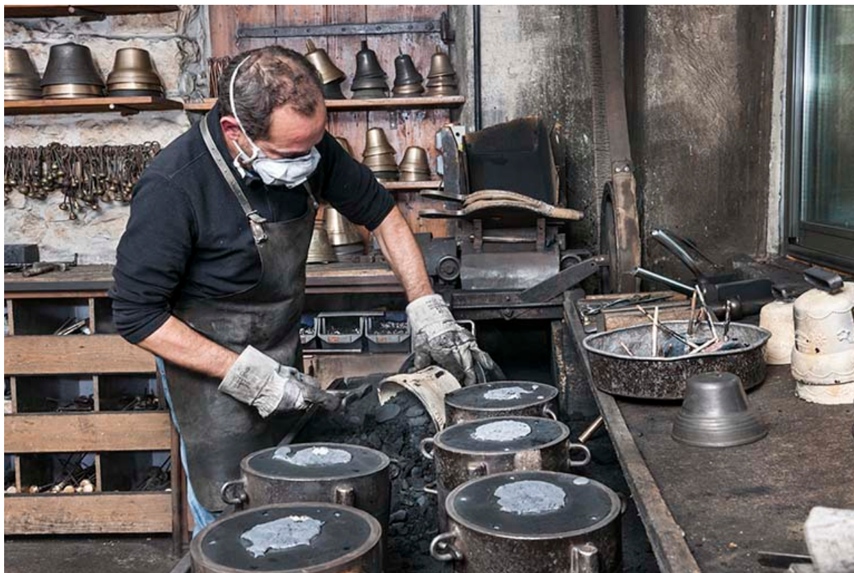
Démoulage. Extraction de la cloche (4).
