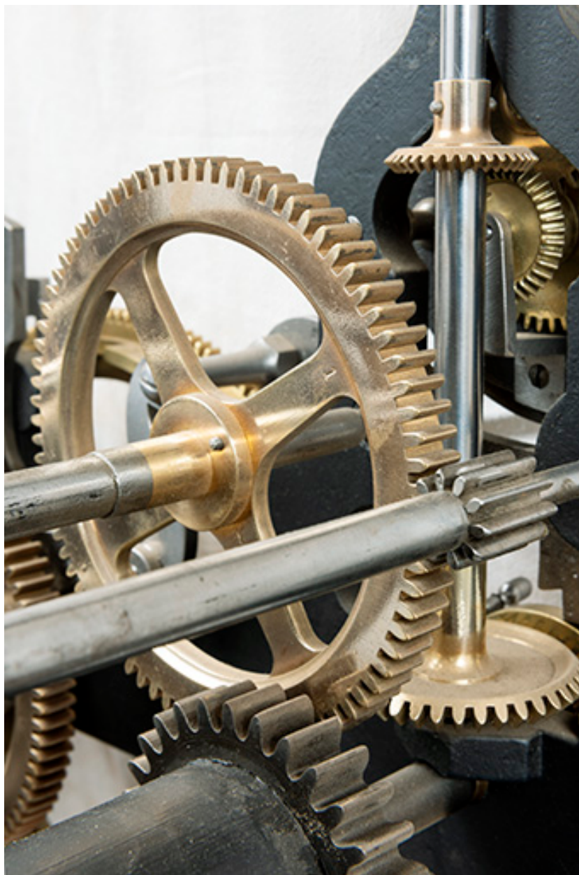
Mouvement, mécanisme des heures : roues, pignons et système de renvoi.
