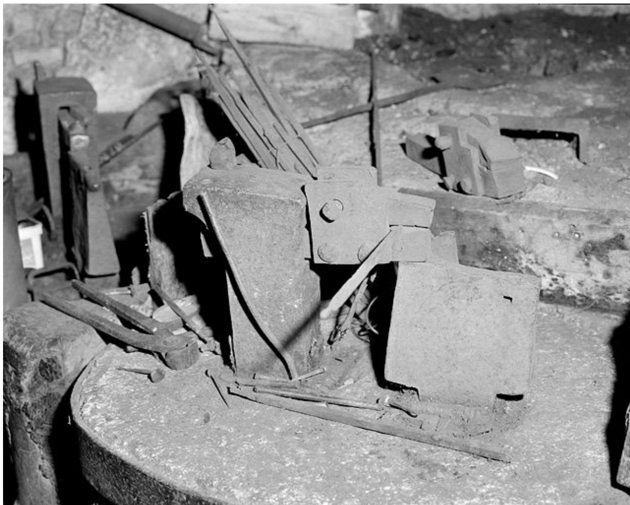
Poste de travail équipé avec une " cloutière ".
