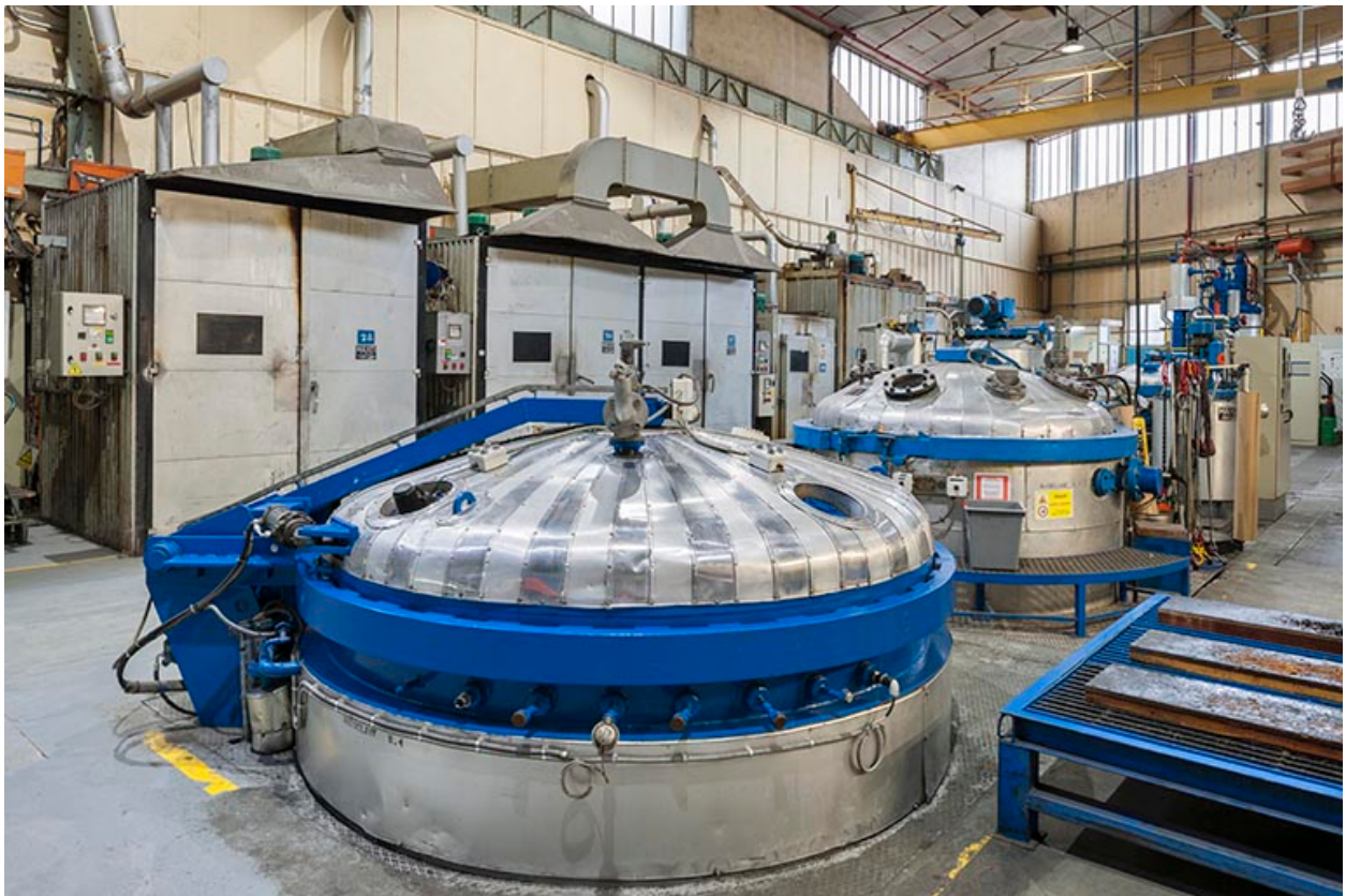
Autoclaves (imprégnation de vernis des stators).
