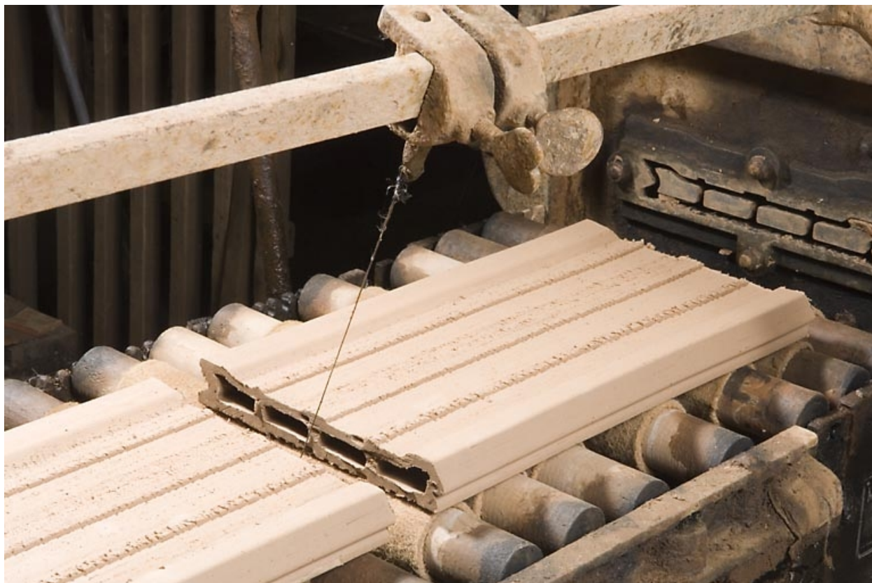
Chariot de la mouleuse-étireuse. Découpage par fil.
